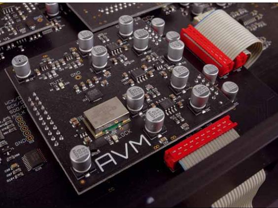
Der ESS-DAC kommt auf einem separaten Modul unter, das für die Einbindung zukünftig erscheinender Hardware ausgetauscht werden kann
