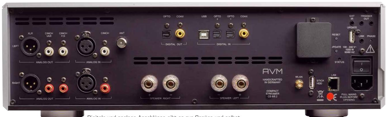
Digitale und analoge Anschlüsse gibt es zur Genüge und selbst an einen UKW-Antennenschluss hat AVM gedacht
