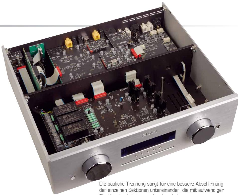
Die bauliche Trennung sorgt für eine bessere Abschirmung der einzelnen Sektionen untereinander, die mit aufwendiger Flachbandverkabelung verbunden sind
