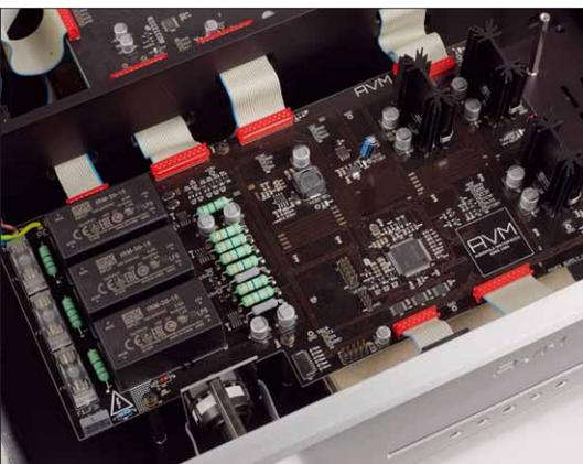
Das neue CPU-Board ist nun für die allgemeine Kontrolle des Systems verantwortlich und wird von einer soliden Metallwand von der restlichen Elektronik getrennt
